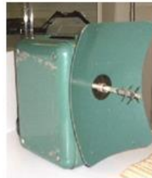
Telurómetro MRA-2 (1956), distanciómetro de ondas radio-eléctricas
