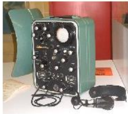
Telurómetro MRA-2 (1956), distanciómetro de ondas radio-eléctricas
